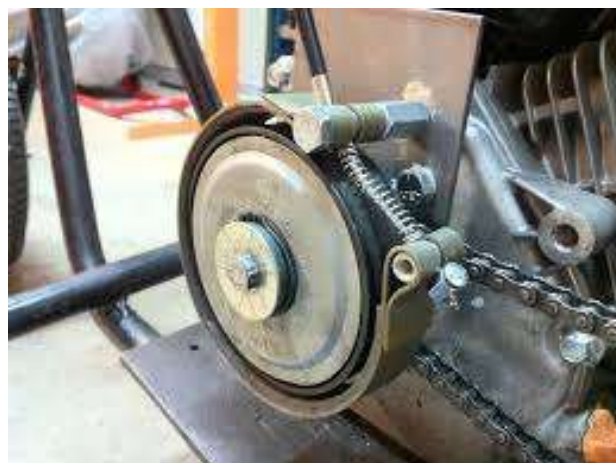
Fig. 1. Typical brake of a mini bike
