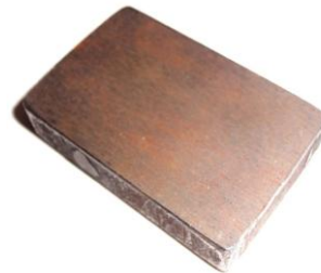
Fig 2: EN 31 steel (Material size-30*20*12mm)
